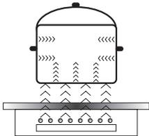
Der Stromgenerator versorgt die im Inneren des Gerätes befindliche Spule.
