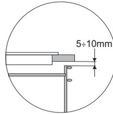
Einbau in der Arbeitsplatte des tragenden Schrankes.
