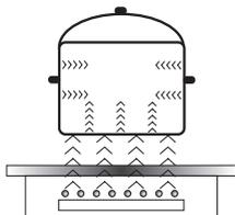
Электрический генератор питает катушку индуктивности, расположенную внутри устройства. Данная катушка создает магнитное поле, которое передается на посуду. Под действием магнитного поля посуда нагревается.
