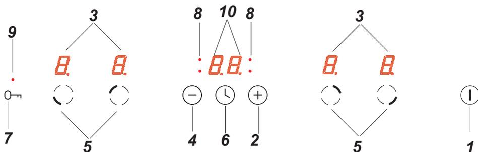
1. Сенсорная кнопка вкл./выкл. варочной поверхности
