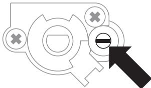
Щоб перевірити полум'я, потрібно прогріти пальник на повному вогні протягом 10 хв., А далі повернути регулювальну ручку вентиля на економне полум'я. Полум'я не повинно згаснути або перескочити на сопло. А якщо так станеться, необхідно повторити регулювання вентилів.
