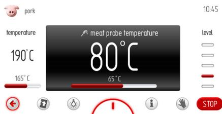
Cuando la sonda térmica no esté conectada a la toma, el icono de ejecución del programa START queda inactivo.
