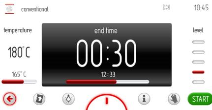
Si durante 60 segundos no activa el programa con la tecla START o no realiza modificaciones de la configuración del tiempo de trabajo o de la temperatura, el programador pasará automáticamente al modo de reloj. La salida inmediata del programa de trabajo será posible pulsando el icono volver . Después de activar el programa, la tecla STOP cambia a tecla START.
