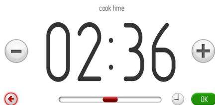
Si en 10 segundos no configura y valida el tiempo de trabajo, el programador pasará automáticamente a la ventana de trabajo del temporizador. La salida inmediata de la pestaña temporizador es posible pulsando
