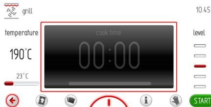
El programa se inicia pulsando la tecla START y pone en marcha el motor de refrigeración, la luz y el calentador del grill. Si durante 10 segundos de activar el programa el usuario no ajusta el tiempo de trabajo o tiempo de inicio de trabajo, las ventanas de temperatura y de tiempo se intercambian de lugar y la temperatura aparece en la parte central del display. La pantalla de trabajo se presenta como a continuación:
