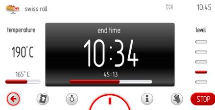
Durante todo el tiempo está mantenida la temperatura del horno, en la ventana del display, en vez de TIEMPO DE TRABAJO se visualiza la descripción TIEMPO DE FINALIZAR (visualizando la hora de terminar el proceso y en la barra de avance el transcurso de los 10 minutos programados.
