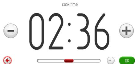
Si durante 10 segundos no configura y valida el tiempo de trabajo, el programador pasará automáticamente a la ventana del programa de trabajo con la función de calentamiento seleccionada. La salida inmediata de la pestaña configuración de tiempo es posible pulsando
