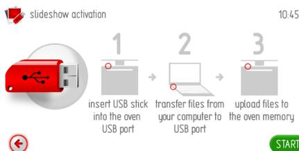
Si durante 120 segundos no coloca la memoria externa en la toma USB del horno y no pulsa OK, el programador pasará automáticamente al modo de reloj. La salida inmediata de la ventana de actualizar aplicación es posible pulsando el icono volver.
