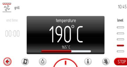
Durante el trabajo el calentador del grill se activa de forma cíclica (por termostato) garantizando la estabilidad de la temperatura del interior del horno con histéresis +/-2,5 °C de la temperatura configurada, es decir, con la temperatura
