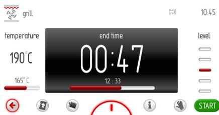
Transcurrido el tiempo de trabajo configurado suena una señal acústica (2 señales / pausa / dos señales), parpadea la iluminación de la pantalla del display. La secuencia de las señales se repite cada 3 segundos. Durante todo el tiempo parpadea también
