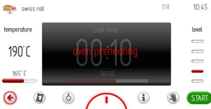
El programa se iniciará después de pulsar START y se conectará el motor de refrigeración, la luz, el motor de turbo y el calentador turbo.
