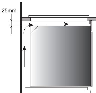
Ventilatsiooniga ahju kohale tööpinna sisse paigaldamine.
