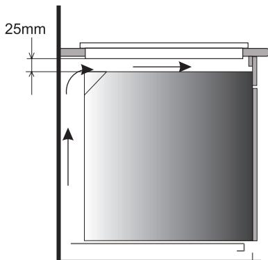
Ugrađivanje u radnu ploču iznad šporeta sa ventilacijom.
