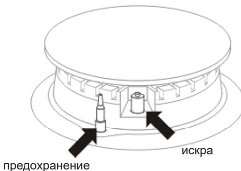
В моделях плит, которые оснащены системой противоутечки газа из конфорок, необходимо во время поджигания придерживать около 10 сек утопленную до упора ручку в положении «сильный огонь», чтобы заработал предохранитель.
