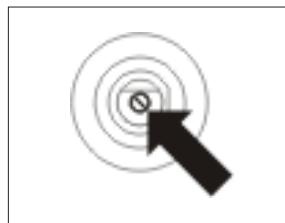
Da bi se proverilo plamen treba zagrevati gorionik u vremenu od oko 10 min., a zatim okrenuti regulator i zaustaviti na poziciji „štедljiv plamen”. Plamen ne sme da se pogasi niti preskoči na mlaznicu. U slučaju da se to ipak dogodi podešavanje ventila treba ponoviti.
