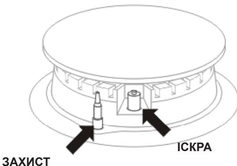
У моделях плит, що оснащені системою противитоку газу з конфорок, необхідно під час підпалу притримувати близько 10 сек. втоплену до упору ручку в положенні «сильний вогонь» , щоб спрацював запобіжник.
