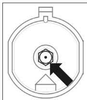
Заміна форсунки пальника - форсунку викрутити за допомогою спеціального ключа насадки 7 і замінити на нову, відповідно до виду газу (див. таблицю).
