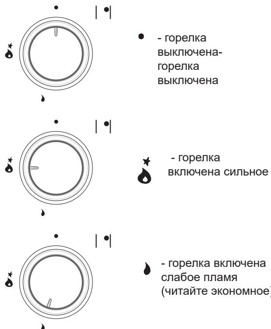
На рис.5 изображено, как правильно отрегулировать пламя горелки.
