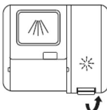
Снять крышку дозатора, поднимая за ручку.
