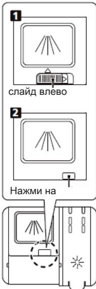
1. Откройте крышку, сдвинув фиксирующий рычаг.
