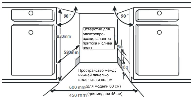
2. При установке посудомоечной машины в угловом шкафчике следует оставить место для открытия дверцы.
