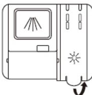
1 Снять крышку дозатора, поднимая за ручку.
