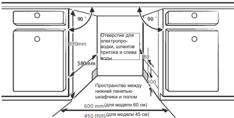
2. При установке посудомоечной машины в угловом шкафчике следует оставить место для открытия дверцы.
