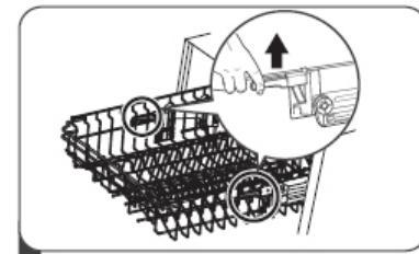
1. Чтобы поднять корзину в верхнее положение, следует поднять ее с обеих сторон на одну высоту. Убедиться, что она хорошо зафиксирована на направляющих.
