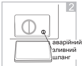
Поверніть на 90° і витягніть шланг для аварійного зливу води та зніміть корок шланга
