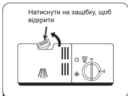
1 Натисніть на фіксор на дозаторі м'яючого засобу 2, щоб відкрити кришку.
