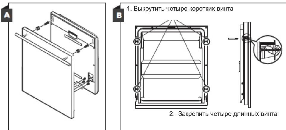
\*Шаг 3. Регулировка сопротивления дверной пружины
