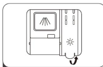
1 Снять крышку дозатора, поднимая за ручку.
