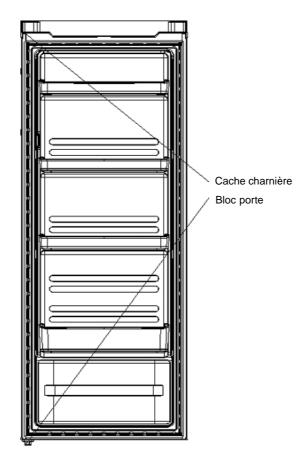
4) Retirer l'écrou, enlever la rondelle puis positionner l'axe de l'autre côté ; la fixer sur la charnière inversée
