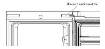
2) Retirer les vis fixées à la charnière supérieure avec un tournevis cruciforme. Enlever la porte et la mettre à plat sur une surface sans risque de rayure
