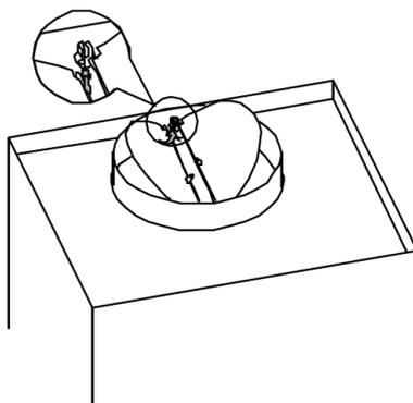
Installez le crochet à un endroit approprié une fois la hauteur d'installation fixée et maintenez-le aligné. Installez aussi le support de fixation de la cheminée intérieure en position haute. (Voir Pic 2).
