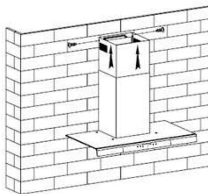
Remarque : Les deux évents de sécurité sont positionnés sur le boîtier arrière, d'un diamètre de 6mm. Fixez le tuyau d'évacuation extensible sur l'ouverture extérieure murale. Fixez le tuyau d'évacuation avec l'attache de câble s'il s'agit d'un tuyau en aluminium.
