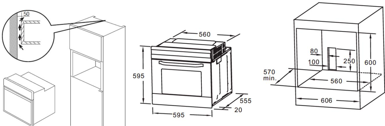
Après avoir encastre le four dans le meuble, ouvrez la porte et fixez latéralement la moulure du four au meuble avec quatre vis (2 de chaque côté), dans les trous prévus à cet effet.
