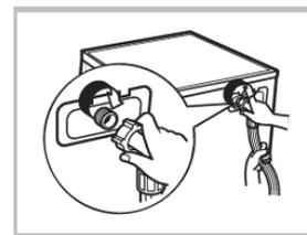
Si nécessaire rectifiez la position du raccord de vidange en vissant la bague de serrage placée à l'arrière de l'appareil.
