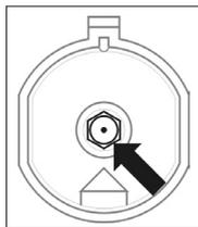
*Changement de l'injecteur du brûleur de la plaque de cuisson – dévisser l'injecteur à l'aide d'une clé d'un diamètre 7 et le remplacer par un injecteur adapté à la famille de gaz (voir tableau ci-dessus).*
