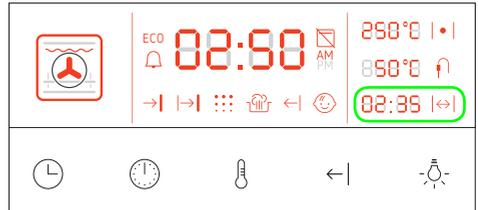
Die Hilfsuhr in der rechten unteren Ecke des Displays erfüllt drei Funktionen je nach dem Betriebsmodus des Backofens (vorausgesetzt dass die Funktionsparameter BETRIEBSZEIT oder STARTVERZÖGERUNG eingegeben sind).
