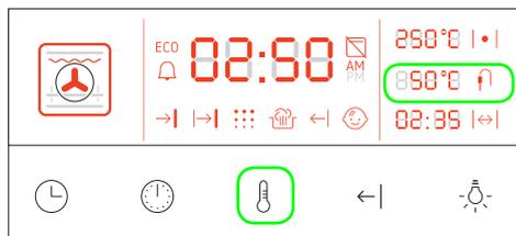
После подключения датчика температуры в каждой позиции **регулятора выбора функции**, кроме ОЧИСТКИ и позиции **0**, на дисплее в месте представленном ниже подсвечиваются символы
