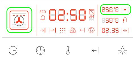
Функции нагревания активируются с помощью **регулятора выбора функции**. В зависимости от версии есть 8 или 10 функций и дополнительная установка **0** – духовка выключена.
