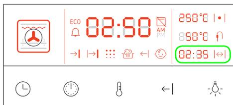
Дополнительные часы в правом нижнем углу дисплея выполняют три функции, в зависимости от режима работы духовки (если параметры функции ПРОДОЛЖИТЕЛЬНОСТЬ РАБОТЫ или ЗАДЕРЖКА СТАРТА введены).
