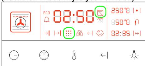
Die Funktion PYROLYTISCHE REINIGUNG besteht aus zwei Stufen: 1/ AUFHEIZEN, 2/ ABKÜHLEN. Beim Aufheizen werden stets die vorgegebene Temperatur von 480°C und das Symbol
