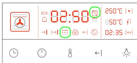
Функция ПИРОЛИТИЧЕСКОЙ ОЧИСТКИ состоит из двух этапов: 1/ НАГРЕВАНИЕ, 2/ОХЛАЖДЕНИЕ. Во время нагревания непрерывно светится заданная температура 480°C и символ **⋮⋮⋮**. После перехода в этап охлаждения высвечивается температура камеры духовки.
