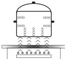
Elektrigeneraator toidab seadmes paiknevat mähist. Mähis tekib magnetvälja, mis kantakse edasi potile. Magnetvälvi põhjustab poti kuumenemist.
