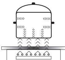
Električni generator napaja induktor koji se nalazi unutar uređaja.
