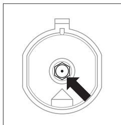
Recambio del inyector del quemador, desatornillar el inyector con una llave tubular nº 7 y sustituir por uno nuevo, conforme al tipo de gas (véase la tabla arriba).
