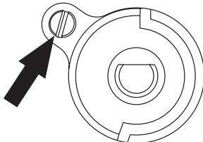
Para comprobar la llama se debe calentar el quemador con la llama completa durante aprox. 10 min., y después cambiar la posición del mando de la válvula a llama económica. La llama no debe apagarse ni saltar al inyector. De ser así, habrá que repetir el ajuste de las válvulas.
