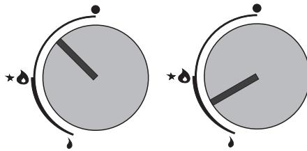
En el ejemplo de manejo del quemador se muestra el manejo correcto consistente en la selección de la llama.
