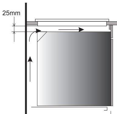
Ventilatsiooniga ahju kohale tööpinna sisse paigaldamine.
