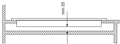
Kapi pealisplati paigaldamine.
