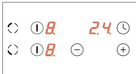
Ako u vremenu od 10 sekundi nijedan senzor nije podešen, grejaća ploča se isključuje. Ako je aktivna zaštita od dece, onda je nemoguće uključivanje grejaće ploče (vidi Deblokada grejaće ploče).
