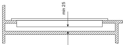
Einbau in der Arbeitsplatte des tragenden Schranks.
