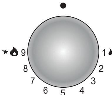
Põleti näite abil on näidatud õiget kasutamist, mis kujutab endast sobiva leegi suuruse valikut. Õige keetmise viis põhineb põleti nupu seadistamisel asendisse „suur leek“ ☹ - kui tahate, et toit keema hakkaks – ja nupu keeramisel asendisse „väike leek“ ☹ (säästlik), kui tahate keeduprotsessi hoida. Leegi suurust võib reguleerida sujuvalt sõltuvalt vajadusest.
