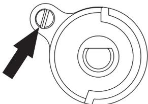
U cilju provere plamena zagreјati plamenik na punoj vatri oko 10 min., a kasnije zavrnuti okretno dugme ventila u poloјaj štedljivog plamena. Plamen ne bi trebao da se ugasi niti da preskoči na diznu. Ako se ipak to desi, ponoviti regulaciju ventila.
