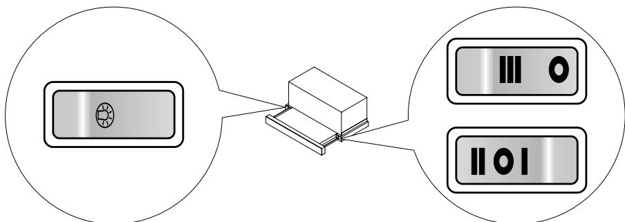
Upravljačka ploča je opremljena tipkama (kolijevka). Tipke su vidljive nakon izvlačenja teleskopske čone ploče.
