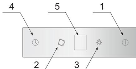
Примечание: Двигатель вытяжки работает только после выдвижения фронтальной панели. Вытяжка снабжена конечным переключателем, каждое выдвижение фронтальной панели вызывает выключение двигателя.
