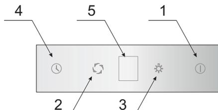
Увага: Мотор витяжки працює лише після висування передньої панелі. Витяжка оснащена кінцевим вимикачем, кожне засовування передньої панелі вимикає мотор.
