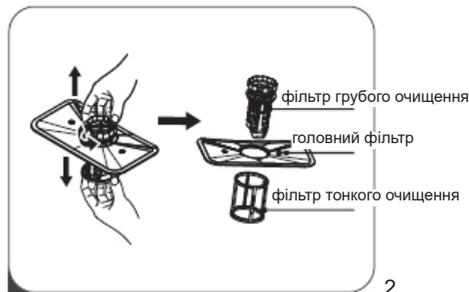
1. Взятися за фільтр грубого очищення і повернути його вліво, щоб відкрити. Підняти фільтр вгору і витягти з машини.
