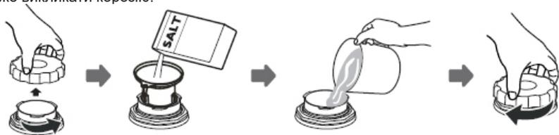
1. Витягти з пристрою нижній лоток та відкрити кришку дозатора.
