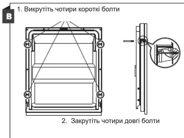
\*Крок 3. Регулювання опору пружини дверцят
