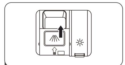
**3** Fermez le couvercle du distributeur en faisant glisser le couvercle vers le bas jusqu'à ce qu'il soit verrouillé.
