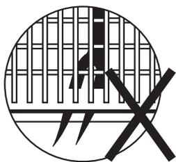
Ne laissez aucun article déborder à travers la partie inférieure. Chargez toujours les ustensiles tranchants avec la pointe effilée orientée vers le bas !
