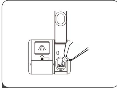
2 Versez soigneusement le liquide de rinçage dans le compartiment en vous assurant qu'il ne déborde pas.
