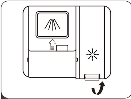
1 Appuyez sur le loquet d'ouverture du distributeur de détergent pour ouvrir le couvercle.
