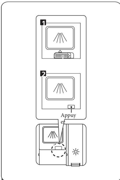
**1** Pour retirer le couvercle du réservoir de produit de rinçage, soulevez la poignée
