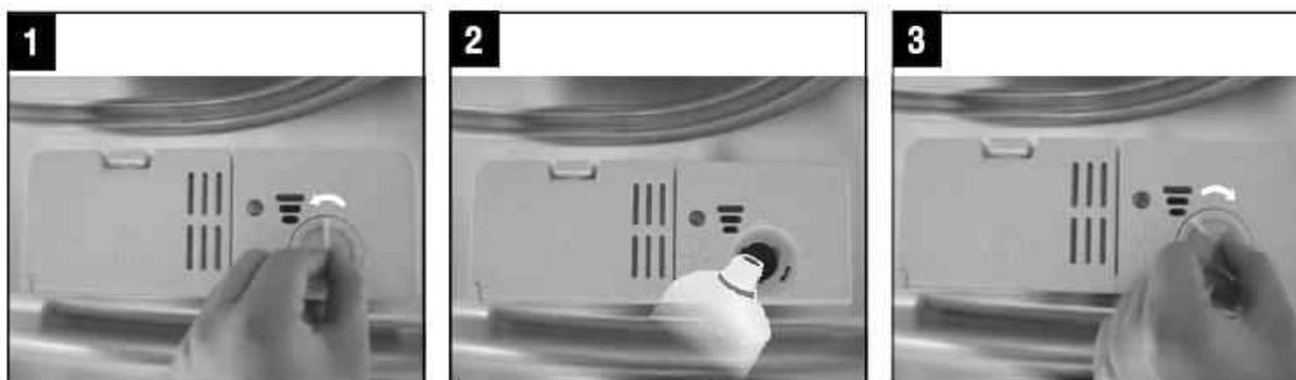
1. Pour ouvrir le réservoir il suffit de tourner le bouchon vers "ouvert" (gauche) et retirer celui-ci
