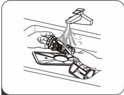
**3** Les gros résidus alimentaires peuvent être nettoyés en nettoyant le filtre sous l'eau du robinet. Pour un nettoyage plus en profondeur, utilisez une brosse souple de nettoyage.
