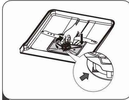
**4** Assemblez les filtres dans l'ordre inverse du démontage, remplacez l'insert du filtre et tournez-le dans le sens des aiguilles d'une montre en direction de la flèche.
