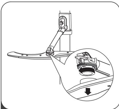
**1** Pour démonter le bras supérieur, tenir l'écrou, faire tourner le bras dans le sens des aiguilles d'une montre et le déloger (ne pas forcer)
