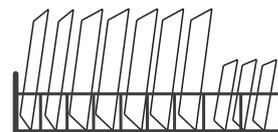
Le diamètre maximal conseillé pour les plats placés devant le distributeur de détergent est de 19 cm, ceci pour ne pas bloquer son ouverture.
