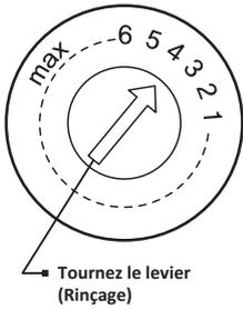
Le réservoir du liquide de rinçage possède six degrés. Le réglage d'usine recommandé est «4 ». Si la vaisselle est mal séchée ou présente des tâches, réglez le cadran sur le chiffre supérieur jusqu'à ce que vos plats ne présentent plus de tâches.
