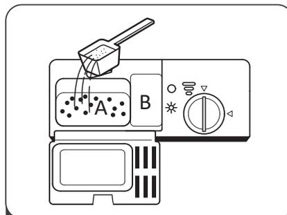
2 Ajoutez du détergent dans la grande cavité(A) pour le cycle de lavage principal. Pour la vaisselle très sale, ajoutez également un peu de détergent dans la petite cavité(B) pour le cycle de pré-lavage.
