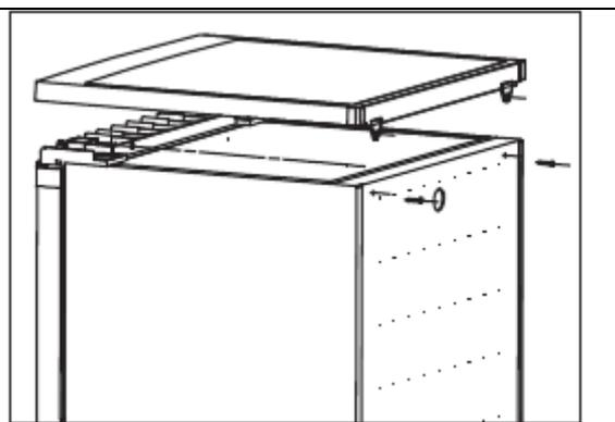
2. Retirez les quatre vis en respectant le diagramme suivant. Soulevez le gond supérieur, puis mettez-le de côté.
