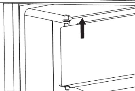
5. Maintenez la porte du congélateur fermée. Fixez le bouton d'installation sur le palier de porte inférieur. Appuyez dessus pour bien l'encastrer dans la cavité prévue à cet effet, et sécurisez le tout avec une vis.
