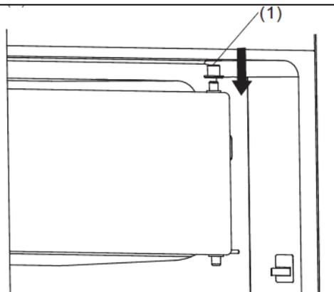
3. Avec un tournevis, faites tomber la boucle d'installation, puis installez-la du côté opposé.
