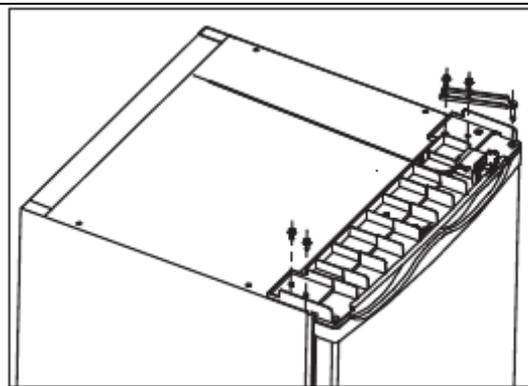
3. Soulevez la porte et placez-la sur une surface rembourrée pour éviter de la rayer. Retirez les pieds ajustables et retirez la charnière du bas en défaisant les vis. Transférez le tout du côté opposé.
