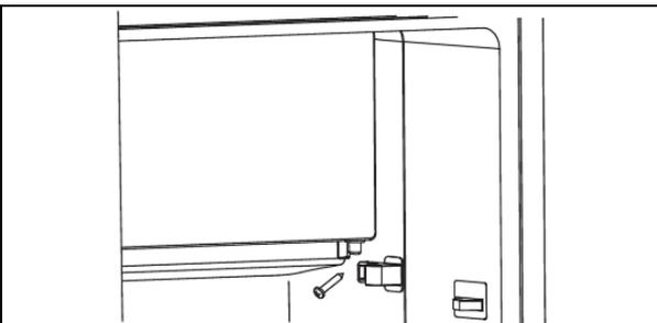
2. Ouvrez légèrement le réfrigérateur. Exercez une pression vers le bas sur la porte du réfrigérateur, ainsi que sur le capuchon de protection du palier de porte (1).
