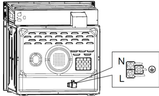
**Important:** le câble d'alimentation doit être positionné de façon à ce qu'aucun point n'atteigne une température supérieure à 50°C au-delà de celle ambiante.
