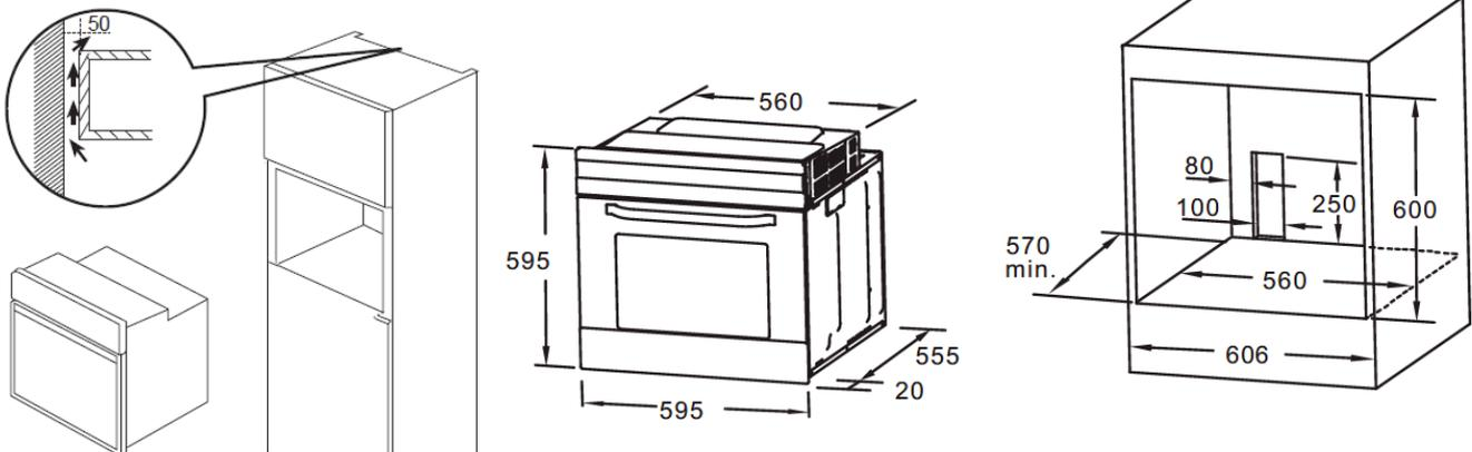
Après avoir encastre le four dans le meuble, ouvrez la porte et fixez latéralement la moulure du four au meuble avec quatre vis (2 de chaque côté), dans les trous prévus à cet effet.
