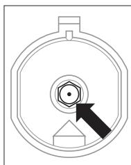
*Promjena sapnica plamenika – sapnicu odvrnuti pomoći specijalnog cjevastog ključa 7 i na njeno mjesto staviti sapnicu za odgovarajuću vrstu plina (vidi tablicu).*
